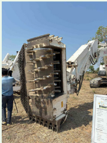
「ロータリーカッター」と「レックグラッpler」を装備した、たくましい灌木除去機
