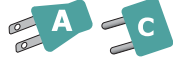
ユニバーサルタイプの差込口 (A・C共用可能タイプ)
