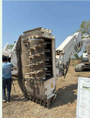
「ロータリーカッター」と「レックグラップル」を装備した、たくましい灌木除去機
