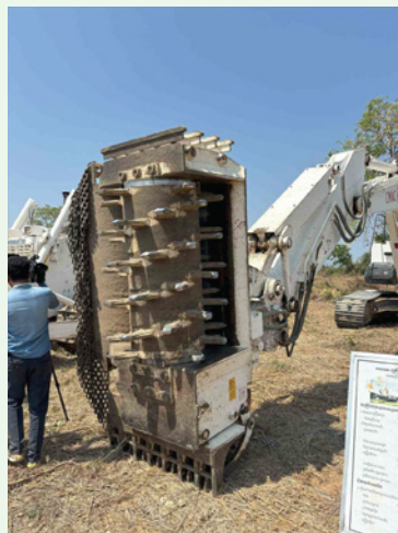
「ロータリーカッター」と「レックグラッブル」を装備した、たくましい灌木除去機
